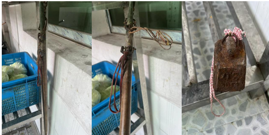
图 II-5 已经生锈模糊刻度的验收工具
