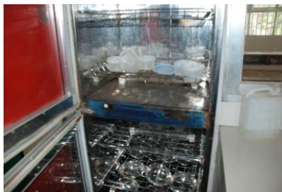
图 10 消毒柜未接电正常使用, 内部已生锈
